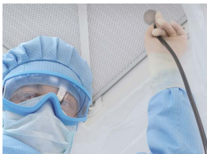
Przeprowadzenie testu szczelności filtrów
